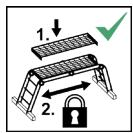
Als de ladder als platform wordt gebruikt, mogen alleen door de fabrikant aanbevolen vlonders worden gebruikt. Het dek moet vóór gebruik worden vastgezet (alleen als dit nodig is vanwege het ontwerp van de ladder).
