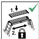
Si l'échelle est utilisée en tant que plateforme, seules des passerelles recommandées par le fabricant de l'échelle peuvent être utilisées. Le pont doit être fixé avant utilisation (uniquement si c'est nécessaire en raison de la conception de l'échelle).
