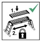
Si la escalera se utiliza como plataforma, solo podrán utilizarse las pasarelas recomendadas por el fabricante de la escalera. La cubierta debe ser inmovilizada antes del uso (solo si es necesario debido al diseño de la escalera).
